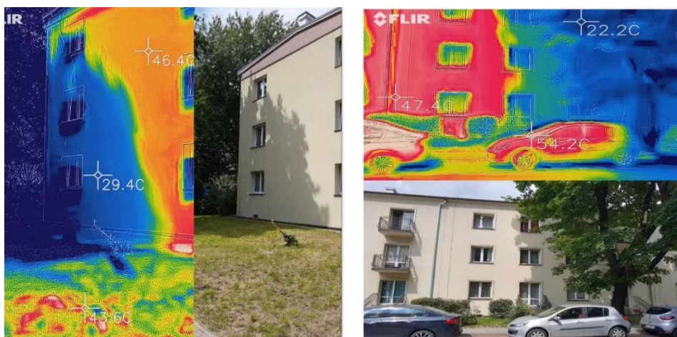
Różnice temperatur przestrzeni z zielenią i bez niej, fot. M. Gawlik, webinarium Zielono-niebieska infrastruktura
